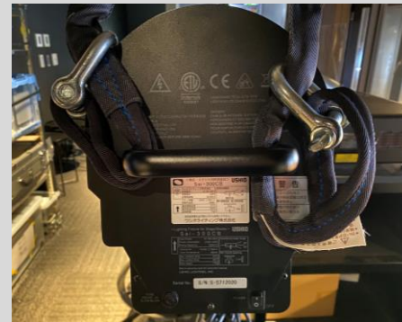
ピンフォースポットライト USHIO LEDフォースポット Sai-300 230w 2台
